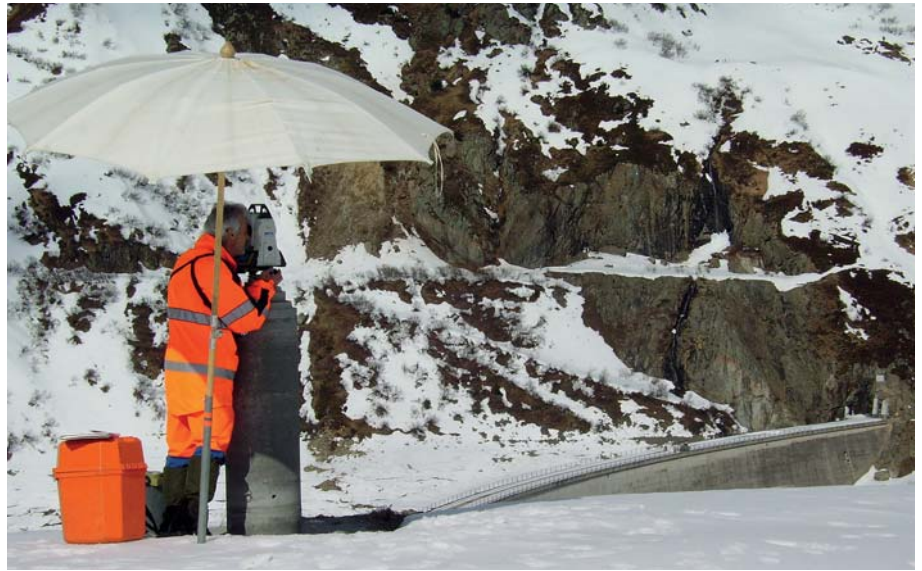
Bild 5. Wintermessung Stauanlage Nalps.
