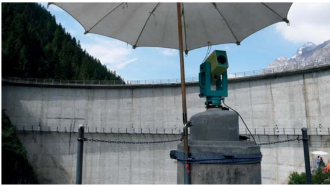
Bild 8. Einsatz des Kern-Mekometers ME5000 bei der Stau-mauer Sufers.
