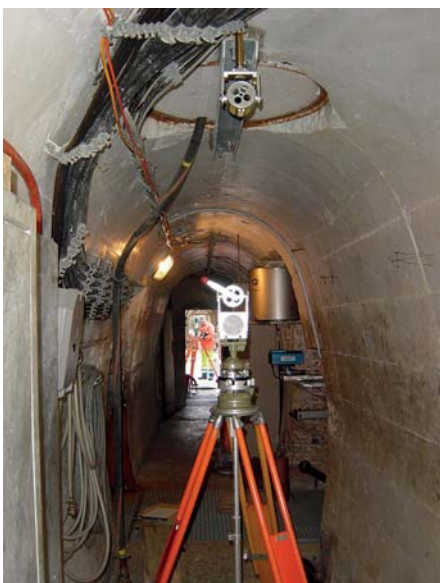
Bild 2. Einmessung eines Lotdrahtes.
